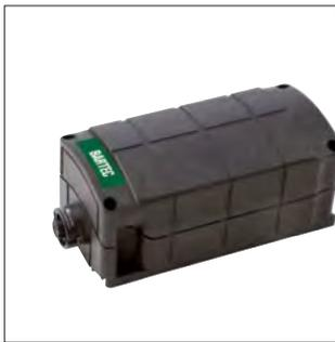
Das Universal-Versorgungsmodul dient der eigensicheren Versorgung (Barriere) und enthält eine Trennstufe (Auswertebarrriere) für die Datenleitungen im Ex-Bereich. Die Datenleitungen können direkt im Ex-Bereich mit Nicht-Ex-Systemen, z. B. PCs, SPS oder Micro-Prozessoren verbunden werden. Über Dip-Schalter kann die Datenschnittstelle die verwendet werden soll eingestellt werden. Durch diese Einstellmöglichkeiten kann eine bestehende Altanlage später einfacher umgebaut und modernisiert werden.
