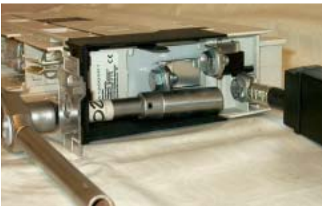
Bild 6: SASIL 2, Sicht auf 3 Klemmen, ein Kabel angeschlossen
